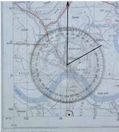
Уношење азимута на карту уз помоћ угламера
